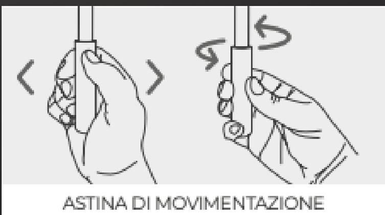
Il trascinarsi orizzontale dell'asta permette l'apertura e la chiusura della tenda, con la rotazione della manopola dell'asta in senso orario e antiorario si movimentano le fasce verticali, regolando così la luce a proprio piacimento.
