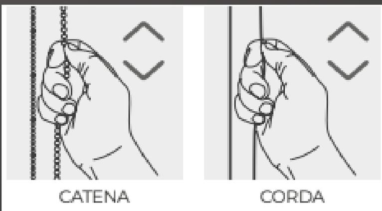
La movimentazione della catena permette l'apertura e la chiusura della tenda, con la corda si movimentano le fasce verticali, orientando a piacimento il tessuto da filtrante ad oscurante.
